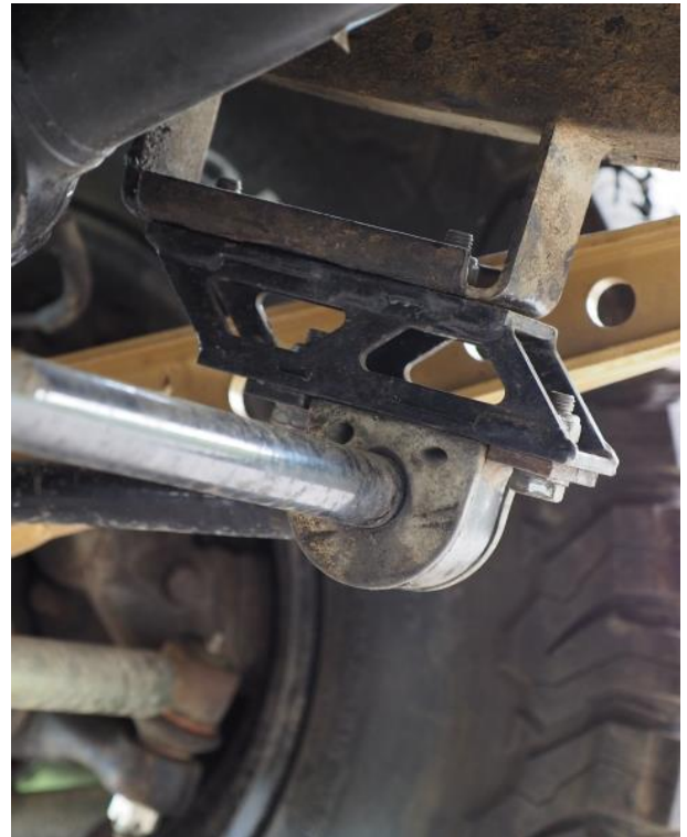
Img.3: sway bar relocator
